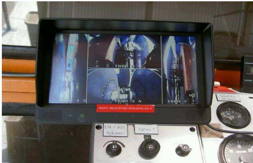
Bei Störungen, insbesondere wenn das Seil von einer Trommel fällt, ist die Antriebswelle mittels Hauptbremse sofort zu stoppen und die Störung zu beseitigen.
